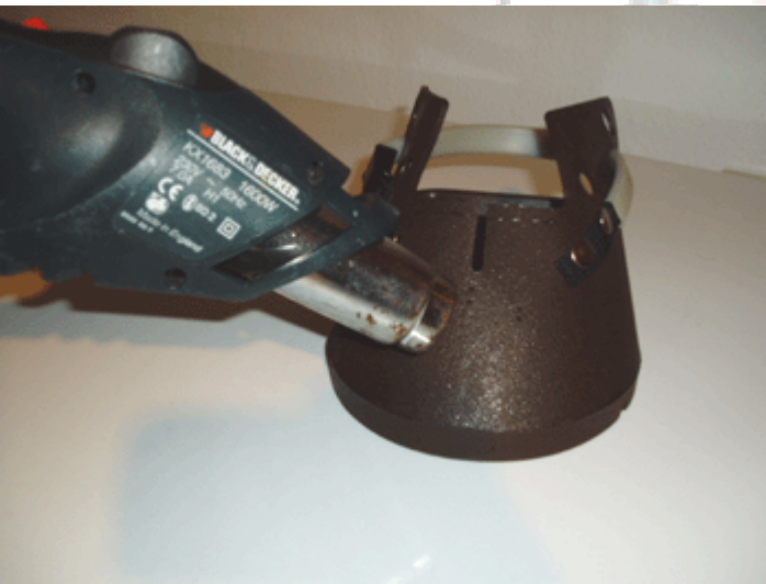
Billede 3 - Tilpasning med varmluft
